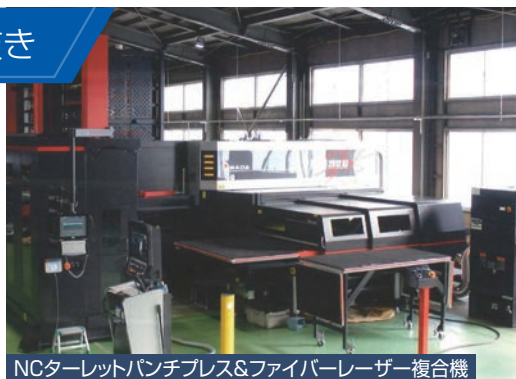
NCターレットパンチプレス&ファイバーレーザー複合機
