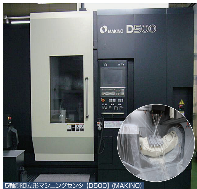
5軸制御立形マシニングセンタ【D500】(MAKINO)
