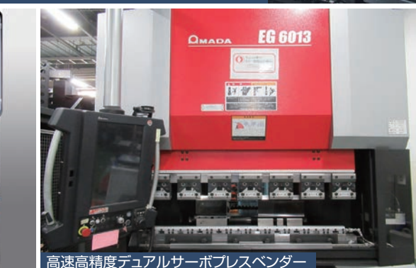
加圧力100t 長さ3,015mm ロボットベンダー
