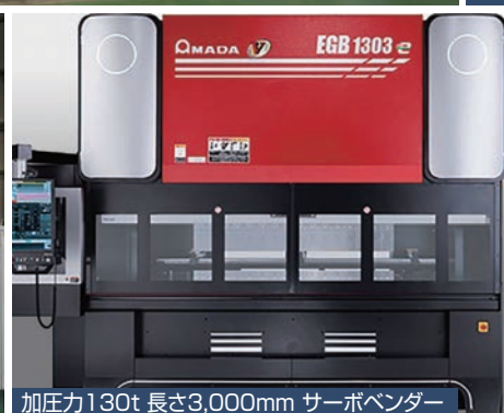
加圧力130t 長さ3,000mm サーボベンダー
