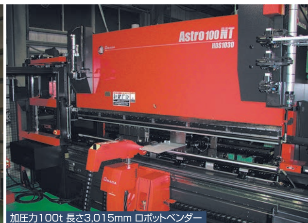
加圧力100t 長さ3,015mm ロボットベンダー
